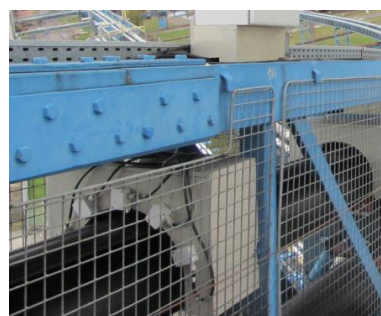
Měřicí jednotka umístěna na hadicovém dopravníku
